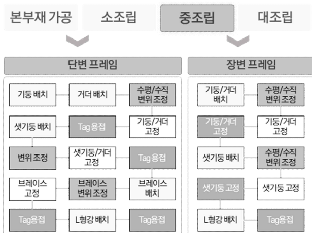
그림 1. 모듈러 스틸 프레임 중조립 제작 프로세스
