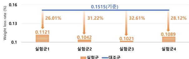
그림 3. TGA 중량감소율 (%) 시험 결과
