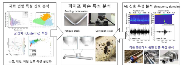
그림 2. 상수도관 재료와 환경에 따른 파이프 결함 및 누수에 대한 AE 및 진동 신호 분석 방안
