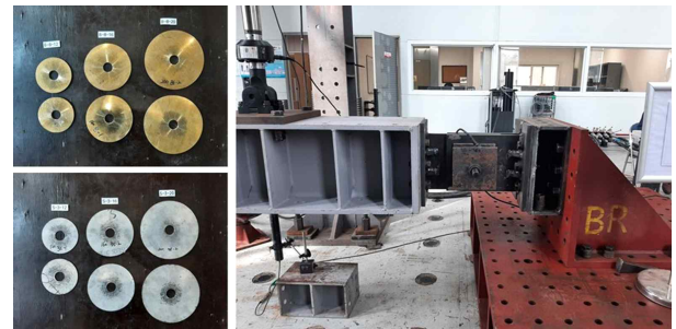
그림 4. 마찰 패드의 재질에 따른 마찰 계수 평가 실험
