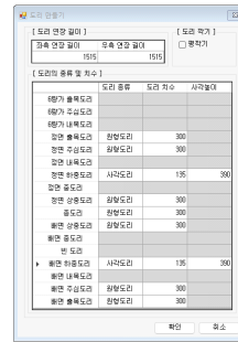
그림 8. 법화전 가상 설계 과정: 도리의 배치
