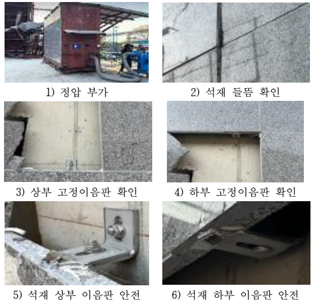
그림 3 석재 긴결부 이음판 보강부위 정압 시험 결과
