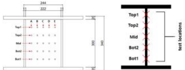
그림 5. 강재 패널 경도 측정 위치
