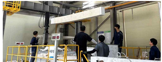
그림3. 수평가열로 내 실험체 설치
