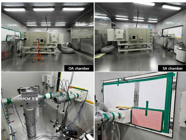
그림 2. 열회수환기장치 열교환효율 측정을 위한 실험 셋업
