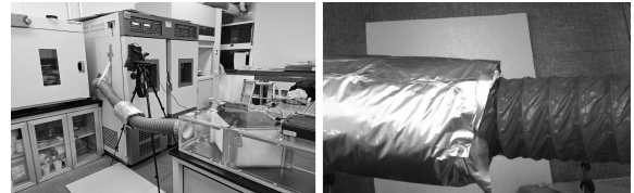
그림 3 플렉시블 덕트 실제 적용 사진
