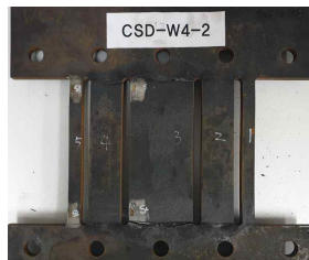
그림 1. CSD-W4 실험체 상세 및 파단형상
