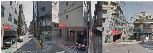
그림1. YOLO를 사용한 필로티 객체 검출
