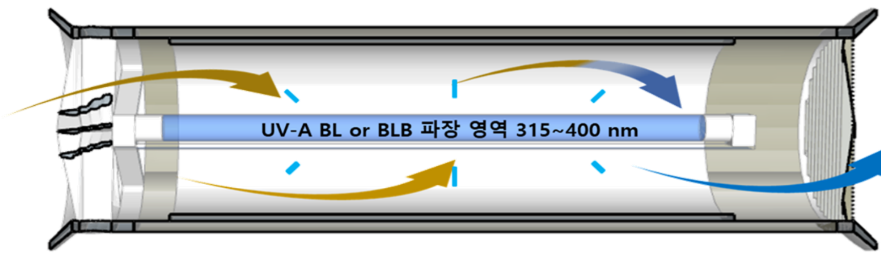
[TiO 2 광촉매 적용 환기장치 개념도 및 작동 원리]
